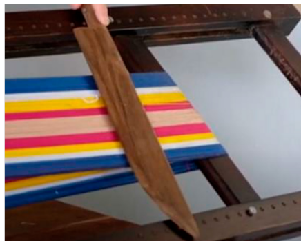
Facão (Machete 16 ) de 44 cm todo de madeira (deve estar bem liso para não estragar a linha)
